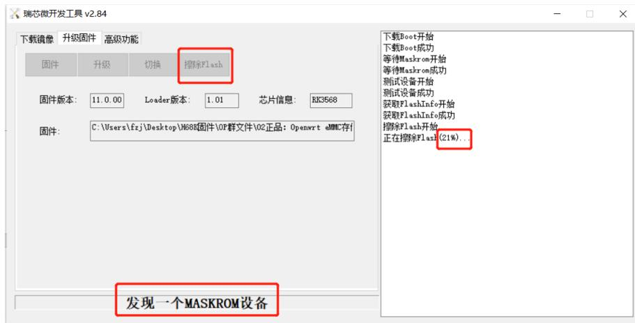
点击【升级】按钮，右边窗口会显示下载进度，等待开机成功之后（1号指示灯闪烁），下载工具会弹出【发现一个 ADB 设备】
